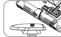
2. Вставьте винт, расположенный на быстросъемной площадке, в гнездо осветителя диаметром 1/4".
