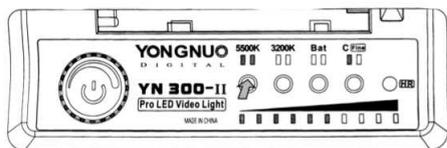
Кнопка 3200k предназначена для регулировки яркости диодов 3200k. Вы можете настроить нужное соотношение цветовой температуры, отрегулировав яркость.
