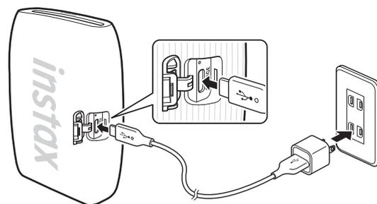
Подключите принтер с помощью прилагаемого кабеля USB Type-C к сетевому USB-адаптеру переменного тока (продается в комплекте с вашим смартфоном), затем подключите USB-адаптер переменного тока к источнику питания в помещении.
